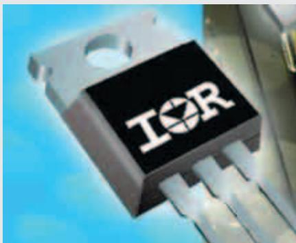
элементов от 4,1 до 5,8 мОм, а у 60-вольтовых элементов – от 3,0 до 4,2 мОм. Они могут поставляться в корпусах TO-220, D2Pak и TO-262, которые квалифицированы для промышленного применения, и MSL1 (наивысший уровень корпусирования). Все типы корпусов не содержат свинца. Для применения 75-вольтовых Synchron-МОП-транзисторов в схеме SmartRectifier IR1167 на myPower-сайте компании IR имеется Online-Design-Software.
