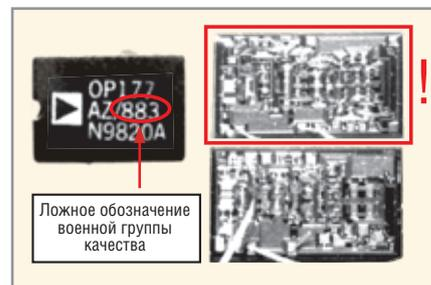
Рис. 3. Различия топологии кристаллов микросхемы OP177/883
