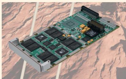
флэш коррекция ошибок, позволяющая исправлять до восьми случайных однобитовых ошибок на 512-байтовый сектор. Модуль имеет аппаратную защиту от записи.
