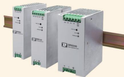
DIN-рейку. Источники питания серии DRS отличаются небольшой шириной по сравнению со стандартными источниками питания и являются одними из самых компактных на рынке источников питания. Ширина моделей серии DRS80 – 32 мм, DRS120 – 40 мм и DRS240 – 60 мм.
