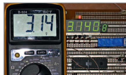
Рис. 4. Плата АЦП с цифровым мультиметром
