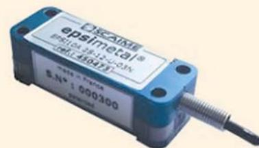
METAL, предназначенные для измерения продольной деформации различных конструкций под статической или динамической нагрузкой. Незначительная жёсткость датчиков позволяет производить измерения в диапазоне 1000 мкм/м с разрешением не менее 1 мкм/м при растяжении или сжатии.
