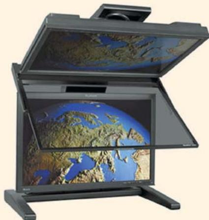
(формат WUXGA). Монитор позволяет просматривать стереоизображение с использованием поляризационных очков. При этом полностью сохраняется разрешение ЖК-панели и частота кадров, а глаза устают не больше, чем при работе с обычным монитором. Технология StereoMirror обеспечивает формирование 3D-изображения посредством двух ЖК-панелей, угол между которыми составляет 110°, и полупрозрачного зеркала, расположенного между ними.
