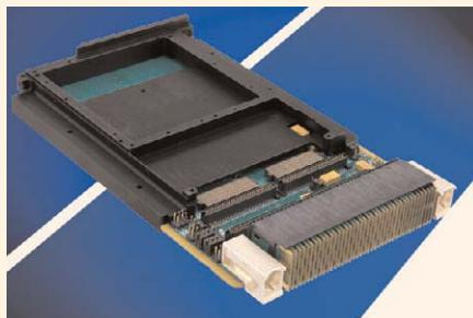
для военных применений – выпустила одноплатный компьютер формата 3U VPX (стандарт VITA 46) на базе двухъядерного микропроцессора Freescale MPC8640D.
