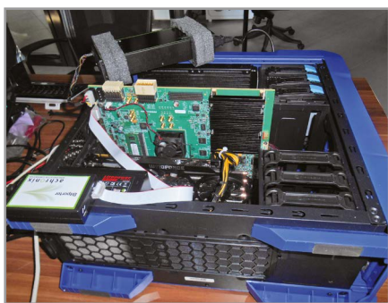
Рис. 5. Плата, вставленная во внутренний разъем PCIe
