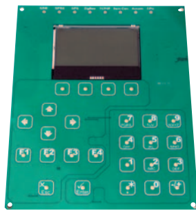
Рис. 7. Сенсорная клавиатура с подсветкой, ЖК-дисплеем и 8 светодиодами состояния
