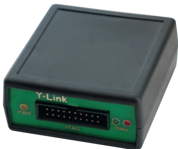
Рис. 6. JTAG-отладчик Y-Link с интерфейсом USB
