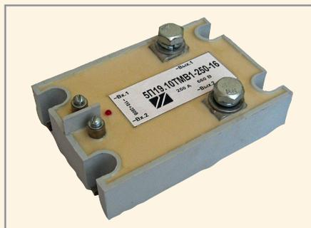
Сильноточные реле отличают малые токи управления, что упрощает применение их в системах автоматики. Включение реле при переходе фазы через ноль способствует более мягкому включению двигателей и повышает ресурс нагревательных элементов. Данные характеристики выгодно отличают твердотельные сильноточные реле от электромагнитных с подобными параметрами. Выпуск реле до 16 класса (включительно) позволяет использовать их в сети с напряжением до 660 В или, например, в сети 220 В с большим уровнем помех.
