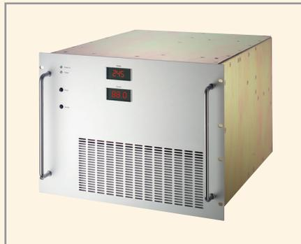
Серия С6400 включают модели для работы от трёхфазных сетей переменного тока 3 × 400 В (320...460 В), 3 × 480 В (400...530 В) с частотой сети 47...400 Гц и сетей постоянного тока 320...640 В, 450...800 В и способны обеспечить на выходе выходные напряжения до 800 В, а ток нагрузки до 360 А.
