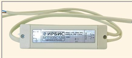
БПТ выпускается с выходным напряжением от 24 до 300 В, выходным током до 1,2 А, мощностью до 40 Вт. Имеет высокий КПД – 92%, гальваническую развязку, комплекс защит, рабочий диапазон температур от –40 до +70°C, обеспечивает стабильность тока  $\pm 5\%$  при всех дестабилизирующих факторах.
