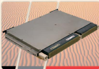
Новый коммуникационный процессор P4080 содержит восемь ядер E500MC с тактовой частотой 1,5 ГГц. Одноплатный компьютер VPX6-187 выполнен в формате 6U VPX и содержит P4080, до 4 Гб DDR3 SDRAM, до 8 Гб NAND Flash, до шести четырёхполосных (x4) порта коммутируемой структуры Serial RapidIO и PCI Express Gen2 на VPX-разъёмах P1 и P2, два слота для мезонинов XMC/PMC, интерфейсы GbE, USB, RS-232/422/485, MIL-STD-1553, Serial ATA и дискретный в/в.
