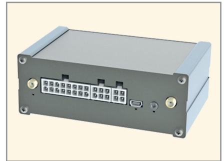
Рис. 7. Вид контроллера в корпусе на базе профилей GB 36 фирмы Fischer Elektronik GmbH
