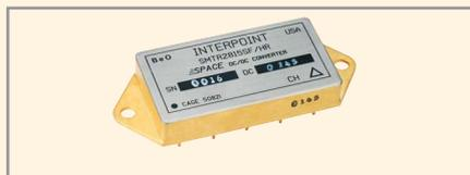
В результате проведённой работы уменьшены влияния каналов друг на друга у моделей с двумя выходными каналами, например, для модели SMTR2815D этот параметр составляет 8%. Порог выходного тока при срабатывании защиты от перегрузки по току повышен до 140% (ранее был 125%). Максимальная емкостная на-
