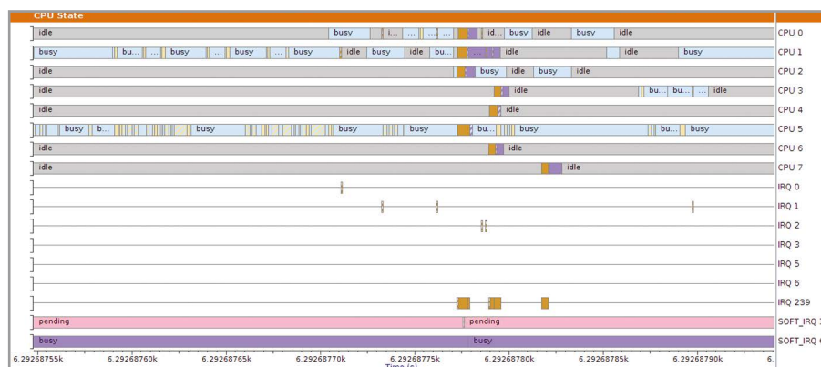
Рис. 4. Просмотр состояния ЦП в окне Sourcery Analyzer
