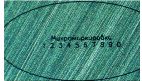
Рис. 3. Микромаркировка по полированному кремнию, высота букв – 50 мкм
