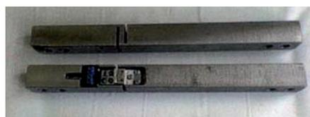
Рис. 3. Внешний вид датчика деформаций
