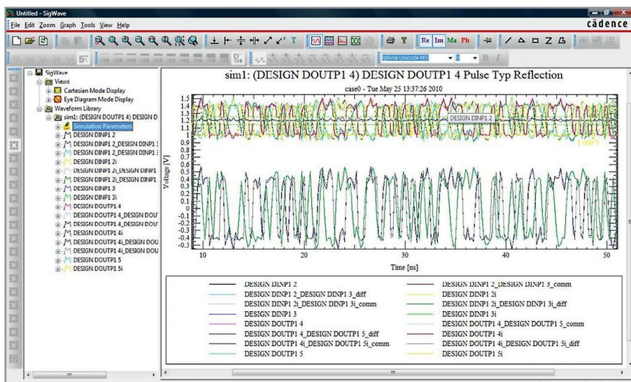
**Рис. 6.** SigWave – приложение, входящее в состав OrCAD Signal Explorer, – выводит на экран осциллограммы сигналов, полученных при моделировании, и обладает широким инструментарием для редактирования и преобразования графиков сигналов
