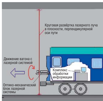
Рис. 1. Схема сканирования пространства и построения совокупности профилей обмеряемого объекта
