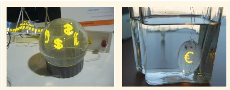
Рис. 14. Прототипы прозрачных ЭЛ-дисплеев, демонстрирующие их пространственную конструкцию
