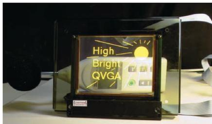
**Рис. 8. Внешний вид прозрачного электролюминесцентного дисплея QVGA**
