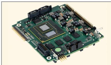
Рис. 1. Встроенный одноплатный компьютер PCIe/104 MICROSPACE® MSMST компании Kontron
