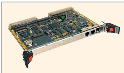
Рис. 9. 6U VME-модуль VP A45/01x компании Concurrent Technologies
