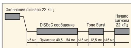
Рис. 3. Управляющая последовательность передачи DiSEqC-сообщения
