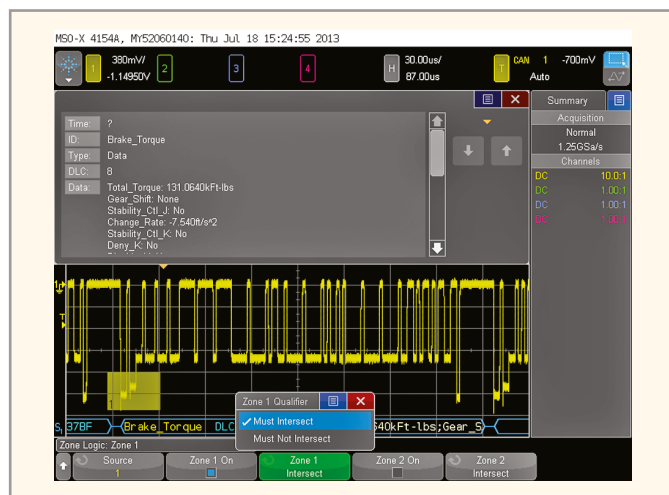
Рис. 3. Применение функции „InfiniiScan Zone“ для запуска по конфликтующим битам
