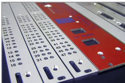
РЭА из алюминиевой плиты. Производство оснащено высокоскоростными фрезерными станками с ЧПУ DATRON (Германия) для обработки пластика, алюминия, цветных металлов и сплавов. Наряду с производством, мы выполняем доработку корпусов известных зарубежных производителей и заготовок панелей, поставляемых вместе с корпусами, с нанесением маркировки методом шелкографии или гравировки.
