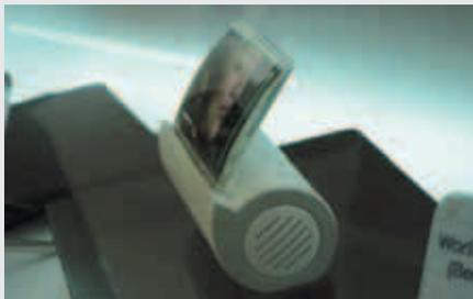
Опытный образец 4" OEL-панели поддерживает разрешение 480 × 272. Благодаря своей тонкости, панель сгибается, и именно в изогнутом состоянии она и была представлена на конференции. Согласно официальным данным, пробный образец панели воспроизводит 16,7 млн. цветовых оттенков, охватывает 100% цветового диапазона согласно национальному телевизионному стандарту (NTSC), характеризуется яркостью 200 кд/м<sup>2</sup>, контрастностью 1000 : 1 и продолжительностью работы 20 000 ч.
