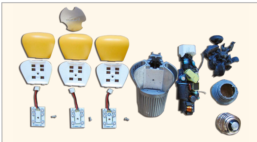
Рис. 5. Светотехнические изделия в разобранном виде: теплоотвод – часть корпуса и плата с дискретными радиоэлементами, составляющими схему источника питания – преобразователя 220 В / 14 В
