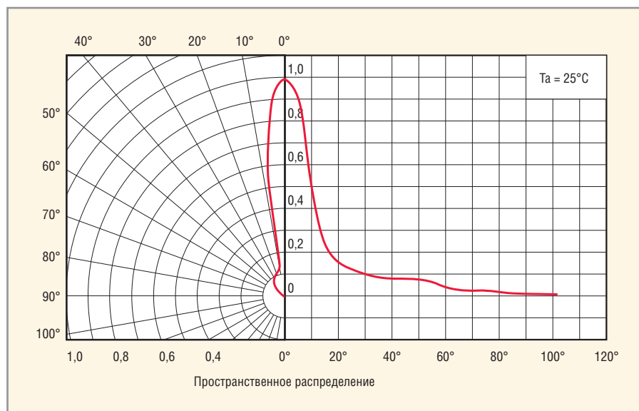
Рис. 4. Диаграмма углового распределения силы света светодиодов серии KAD1-1010
