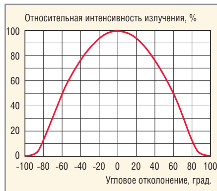
Рис. 2. Диаграмма углового распределения светового потока светодиодов серии KA-8070/3
