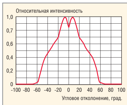
Рис. 15. Диаграмма распределения силы света светодиодов серии L7679
