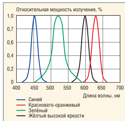
Рис. 7. Спектральные характеристики светодиодов серии KTDG-8080
