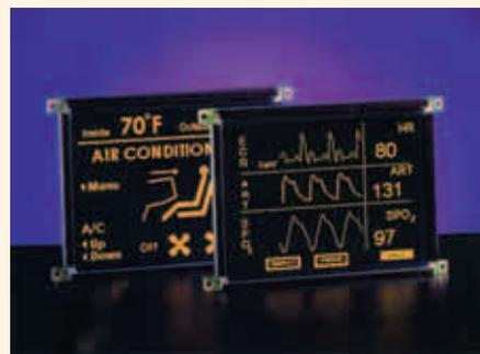
бликов и при этом обеспечивает передачу 90% яркости изображения. Покрытие рассеивает зеркальные отражения света, что значительно уменьшает блики и улучшает качество считываемого изображения. В качестве материала для антибликового покрытия применяется плёнка Lexan HP40S, которая отличается весьма высокой долговечностью, великолепной стойкостью к истиранию и воздействию многих химических веществ, что в сочетании со стойкой адгезией делает её прекрасным выбором для уменьшения бликов изображения.
