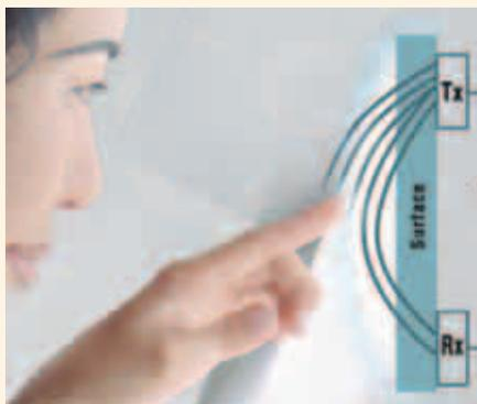
быстроту срабатывания по сравнению с предыдущими моделями, и отличается упрощённой одноэлектродной конструкцией. Используемый в этом приборе активный экран исключает помехи от земли и других возможных источников шума и позволяет располагать сенсор вдали от интегральной схемы без ущерба для рабочих параметров.
