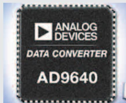
Элемент предлагается с разрешением 12 и 14 разрядов, с частотой опроса 80, 105, 125 и 150 Мвыборок/с и имеет CMOS- и LVDS-выходы. Обе версии размещены в корпусе LFCSP (Lead-Frame Chip-Scale Package) размером  $9 \times 9$  мм с 64 выводами.
