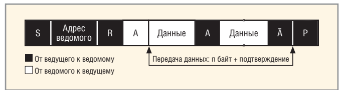
Рис. 22. Формат обмена данными по шине I 2 C для режима ведомого передатчика
