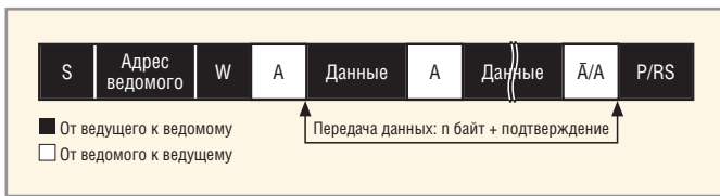
Рис. 21. Формат обмена данными по шине I 2 C для режима ведомого приёмника
