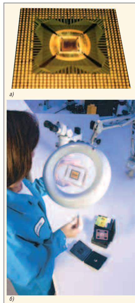
Рис. 1. Спутниковая электронная компонентная база (а) и визуальный неразрушающий контроль (б)
