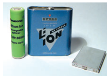
Рис. 1. Литий-ионные аккумуляторы различных конструкций: цилиндрический типоразмера 18650 ёмкостью 1,7 Ач, призматический для сотового телефона ёмкостью 0,7 Ач и призматический с рулонной сборкой пластин ёмкостью 6,8 Ач
