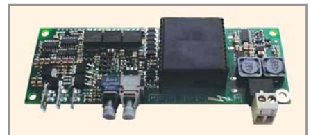
Рис. 9. Драйвер управления C0044BG400
