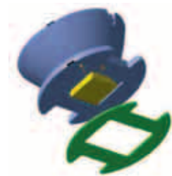
Рис. 13. Принцип крепления линзы на плату
