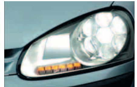
Рис. 7. Концептуальная разработка: автомобильная светодиодная фара
