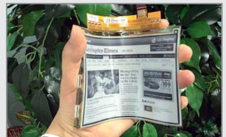
Толщина дисплея, по данным LG, составляет 0,7 мм, что соответствует толщине защитной плёнки для смартфонов. Компания проводила тесты по падению экрана с высоты 1,5 м и ударам при помощи резинового молотка по нему без негативных последствий. Пока такие экраны лишь позволяют уменьшить толщину устройств, несколько улучшить их ударопрочность и гибкость при использовании специальных корпусов. Быть может, когда-то будут изобретены гибкие батареи, которые улучшат характеристики подобных продуктов?
