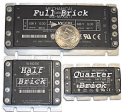
Рис. 1. Стандартные типоразмеры преобразователей
