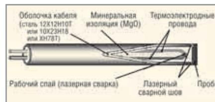
Рис. 1. Устройство термопарного кабеля
