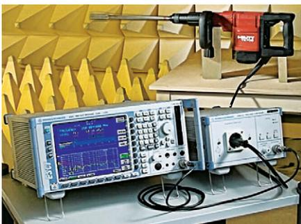
Рис. 1. Общий вид комплекса для измерения ЭМС
