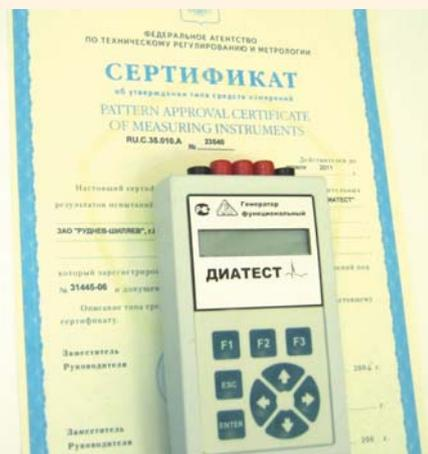
калибровочных сигналов для первичной и периодической поверки одноканальных и многоканальных электрокардиографов отечественного и зарубежного производства.
