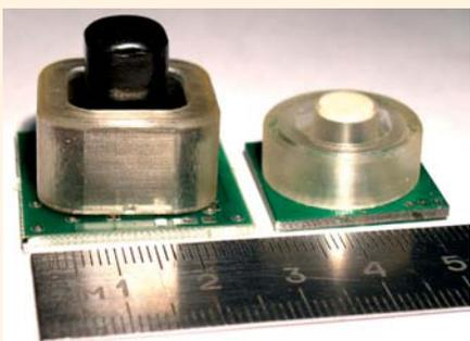
Также стоит отметить программируемость ядра, позволяющую настроить работу чипа под конкретные внешние условия (яркость светового объекта, фоновый шум); возможность определения площади захваченного объекта, совместимость с интерфейсными контроллерами, низкую стоимость.
