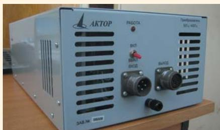
Для организации рабочих мест по регулировке и настройке изделий авиационной техники удобно использовать преобразователи напряжения, разработанные и производимые ООО «АКТОР», г. Москва.
