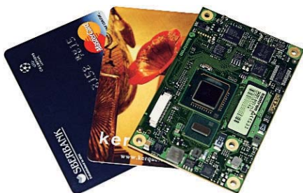
Рис. 2. Габариты модулей nanoETXexpress примерно соответствуют размерам стандартной кредитной карточки
