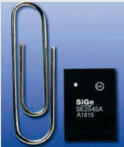
Модуль SE2545A10 является HF-Frontend-модулем, состоящим из двух полных двухполосных приёмопередающих цепей ( $2 \times 2,4$  ГГц Tx,  $2 \times 5$  ГГц Tx,  $2 \times 2,4$  ГГц Rx и  $2 \times 5$  ГГц Rx), которые требуются для работы в режиме MIMO (Multiple Input, Multiple Output). По данным производителя, модуль заменяет до 60 дискретных компонентов, так как все части схемы между трансивером и антенной размещены в единственном корпусе CSP (Chip-Scale Package).
