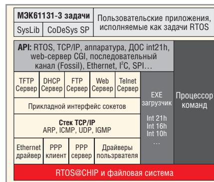
Рис. 2. Архитектура RTOS IPC@CHIP, реализованная в SC13-IEC
