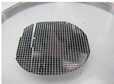
**Рис. 1. Пластина, содержащая миниатюрные магниточувствительные элементы, выполненные стандартными методами фотогравировки**
