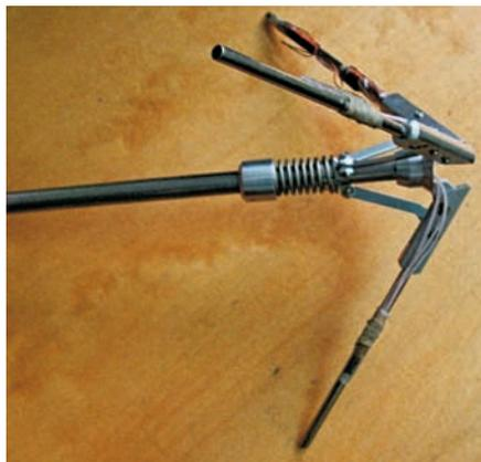
**Рис. 3. Датчик магнитного поля в раскрытом состоянии**
