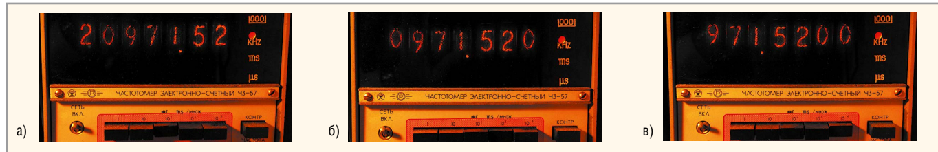
Рис. 18. Фотографии показаний частотомера, измеряющего частоту тактового генератора при различном времени (Т) измерений
