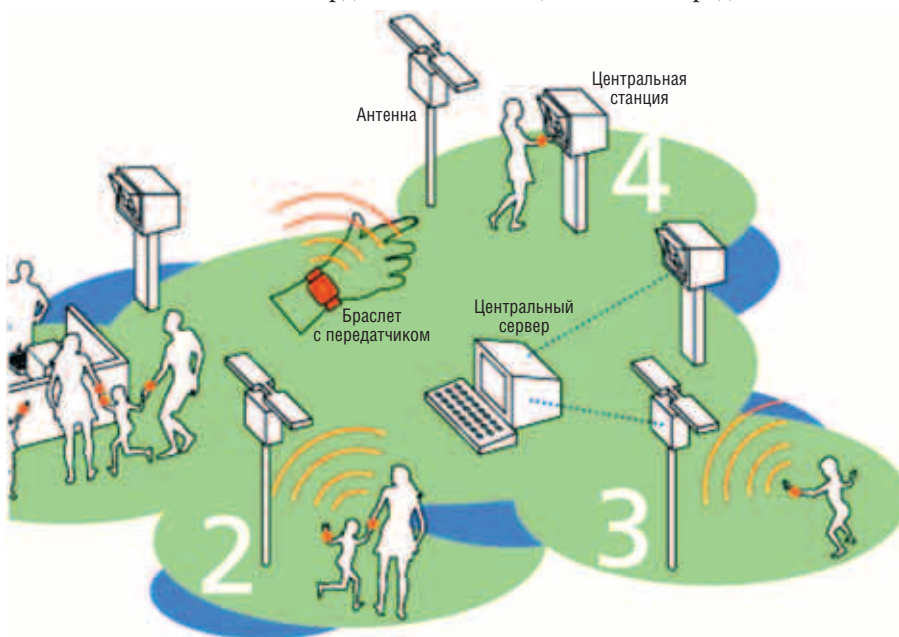
Рис. 1. Структура локальной навигационной системы SafeTzone
