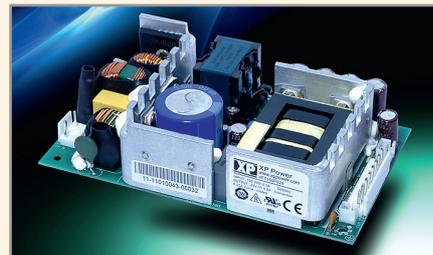
способны обеспечивать в нагрузке полную мощность 150 Вт при принудительном обдуве воздушным потоком 15 CFM. При использовании только конвекционного охлаждения модули обеспечивают мощность до 100 Вт. Габариты модуля 76,2 × 127 × 33,2 мм.
