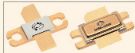
Преимущества Microsemi GaN-on-SiC: Vbr стока выше 350 В, что позволяет транзистору работать со смещением стока в 60 В, обеспечивая значительно более высокую надёжность устройства по сравнению с транзисторами, произведёнными по LDMOS-технологии. Более высокое напряжение смещения стока увеличивает пиковую выходную мощность, а более удобные в использовании значения импеданса устройства упрощают согласование.
