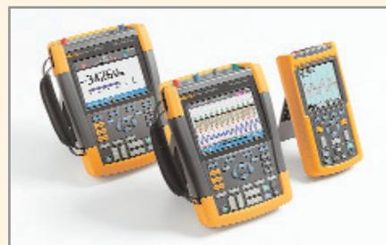
к электrorаспределительной сети. Эти переносные приборы, работающие от аккумуляторов, имеют герметичные корпуса, обеспечивающие защиту от пыли и брызг, с рейтингом IP-51, чтобы выдерживать тяжёлые промышленные условия. Новые функции помогут справляться с задачами поиска неисправностей в современных электронных системах, а усовершенствования, такие как длительное время работы аккумулятора и обмен данными через USB, оптимизируют ваше рабочее время и облегчат выполнение некоторых операций.
