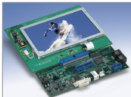
Рис. 5. Плата видеобработки с подключенным модулем ЖК-дисплея
