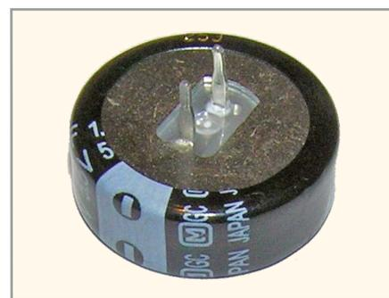
Рис. 2. Внешний вид ионистора DC-2R4D225 ёмкостью 1 Ф на напряжение 5,5 В (модель 1905V)
