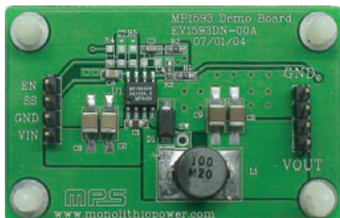
Оценочная плата понижающего DC/DC-преобразователя MPS EV1593DN-00A на базе ИС MP1593
