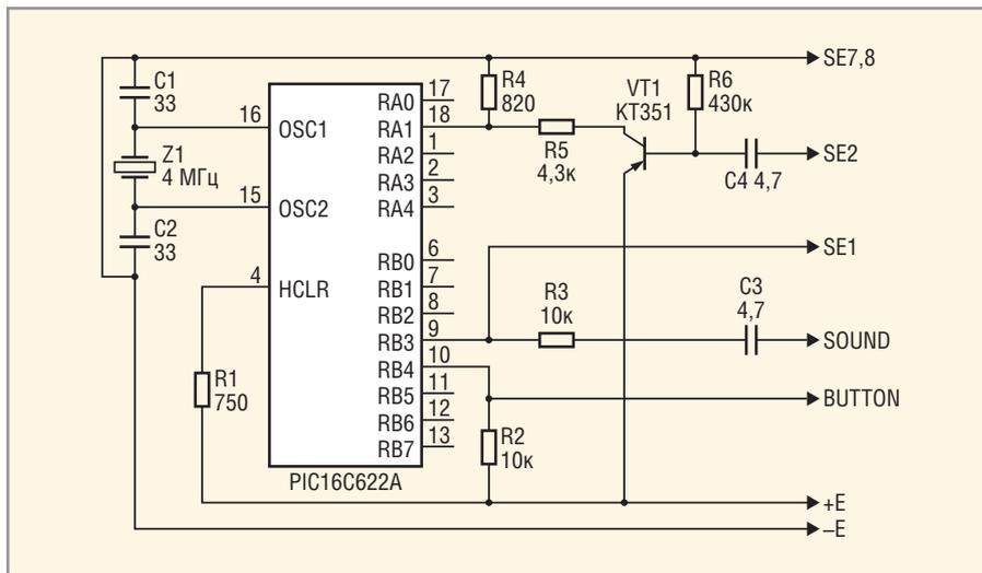
Рис. 2. Электрическая схема устройства, реализующего дистанционное измерение температуры
