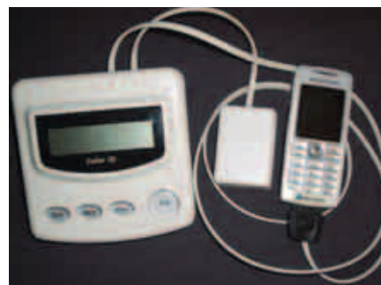
Рис. 3. Энергосберегающий регулятор температуры на базе двух микроконтроллеров с часами реального времени
