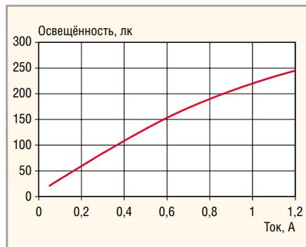
Рис. 2. Зависимость освещенности прибора FH411A от прямого тока
